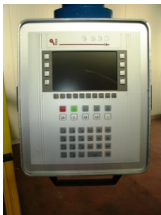
Particolare del CNC ESA S530 a 4 assi (Y1 + Y2 + X + R)
